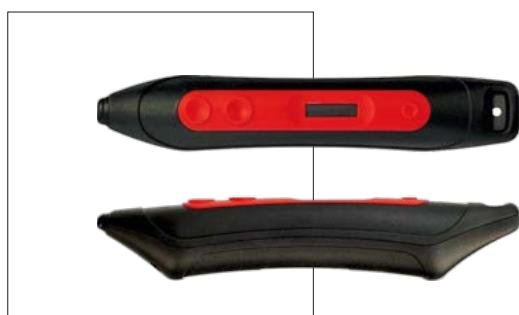
Le RFID X-IS est un lecteur portatif permettant la lecture simple et efficace d'étiquettes RFID/NFC soit par contact direct soit à distance lorsque les étiquettes sont difficilement accessibles. Les informations contenues dans l'étiquette peuvent être lues directement sur l'écran OLED, transmises par Bluetooth ou être récupérées depuis la mémoire interne via le port USB.
