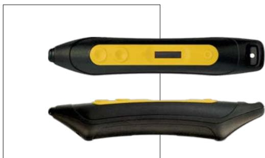
Le RFID X-NI est un lecteur portatif permettant la lecture simple et efficace d'étiquettes RFID/NFC soit par contact direct soit à distance lorsque les étiquettes sont difficilement accessibles. Les informations contenues dans l'étiquette peuvent être lues directement sur l'écran OLED, transmises par Bluetooth ou être récupérées depuis la mémoire interne via le port USB.
